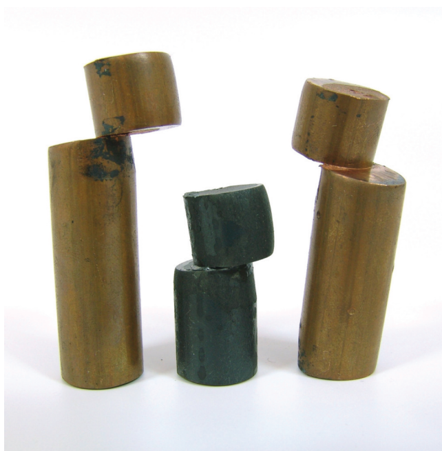
ΣΧΗΜΑ 1.3 Αστοχία απλής διάτμησης σε δοκίμια πείρων.
