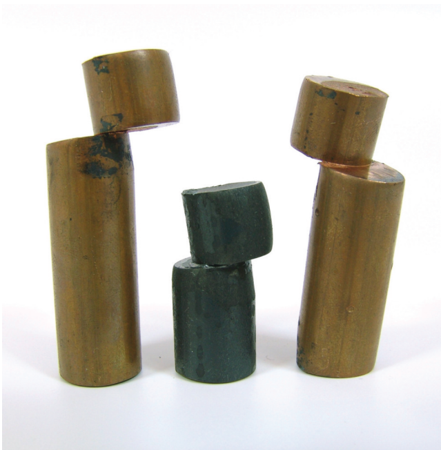
ΣΧΗΜΑ 1.3 Αστοχία απλής διάτμησης σε δοκίμια πείρων.
