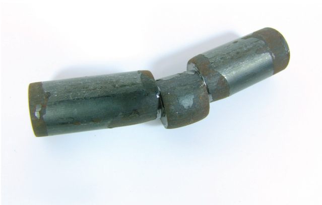
ΣΧΗΜΑ 1.4 Αστοχία διπλής διάτμησης σε ένα δοκίμιο πείρου.
