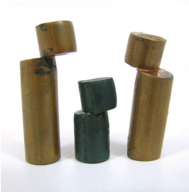
ΣΧΗΜΑ 1.3 Αστοχία απλής διάτμησης σε δοκίμια πείρους.
