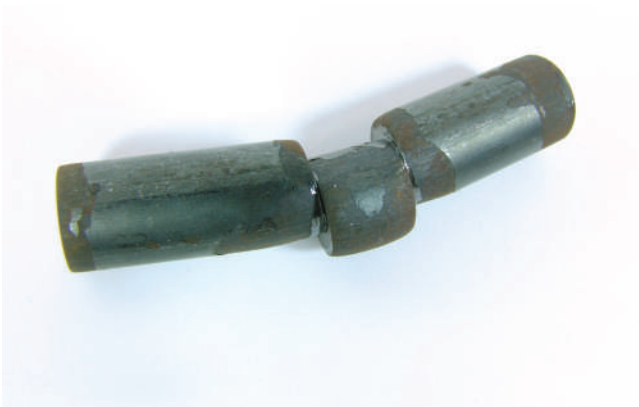
ΣΧΗΜΑ 1.4 Αστοχία διπλής διάτμησης σε ένα δοκίμιο πείρο.
