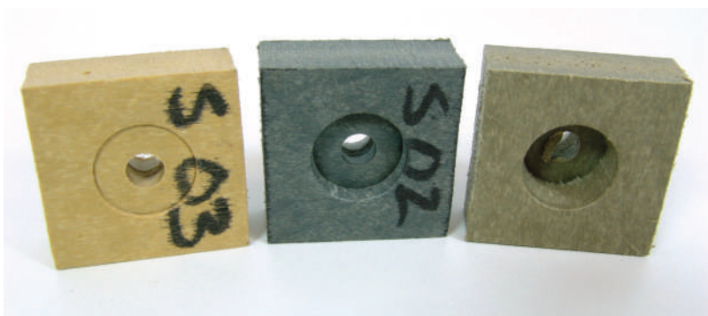
ΣΧΗΜΑ 1.5 Αστοχία σε διάτμηση λόγω διάτρησης σε δοκίμια από κομμάτια σύνθετου ξύλου.
