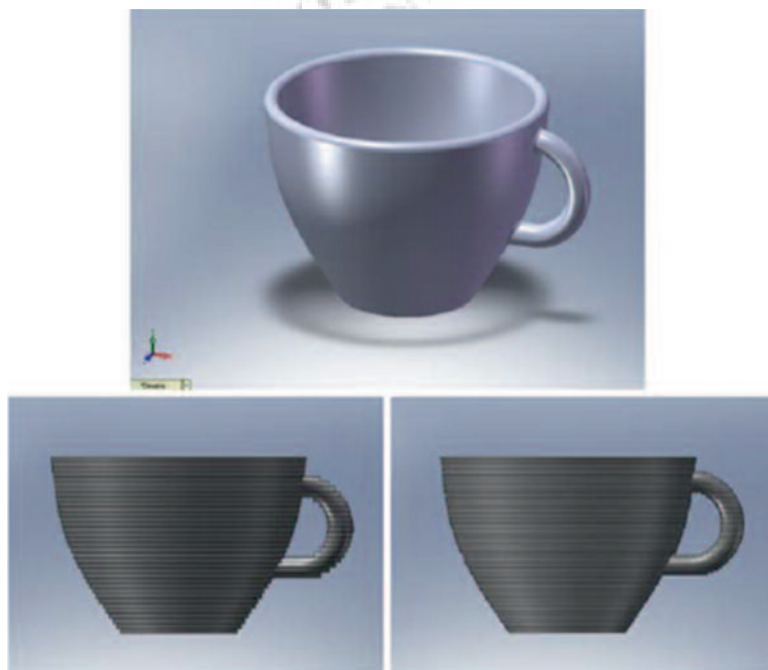
Εικόνα 1.1 Απεικόνιση ενός φλιτζανιού τσαγιού σε σύστημα CAD μαζί με επιπλέον απεικονίσεις στις οποίες διακρίνεται η επίδραση που έχει στο κατασκευαστικό αποτέλεσμα το διαφορετικό πάχος στρώσης.
